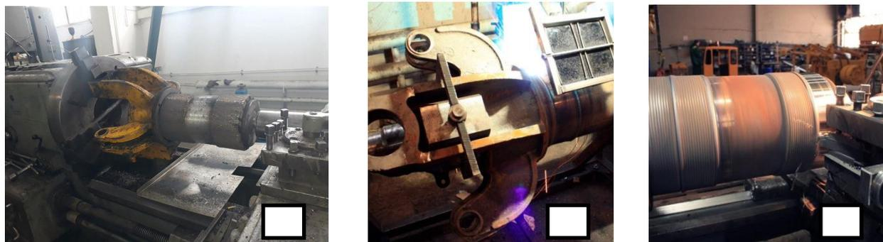
Рисунок 2 – Восстановление оси вертикального шарнира рамы трактора К-744
