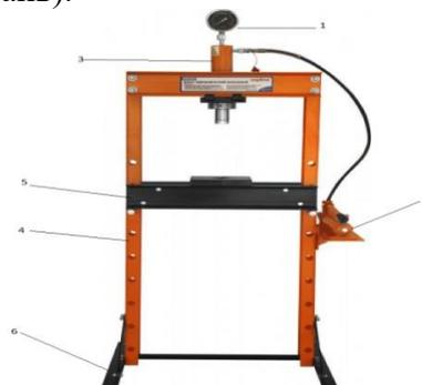
**Рисунок 2 – Пресс гидравлический OMBRA
