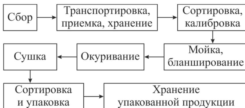
Рисунок 1 – Технологическая схема переработки абрикосов для получения кайсы, кураги и урюка
