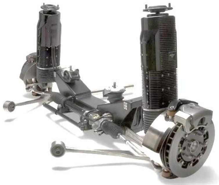
Рисунок 1 – Электромагнитная подвеска компании Bose
