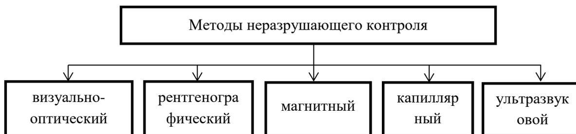
Рисунок 1 – Основные методы неразрушающего контроля
