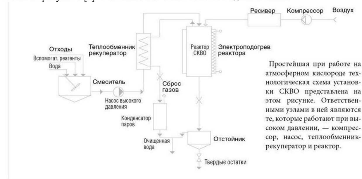
**Рисунок 1– Технологическая схема**
