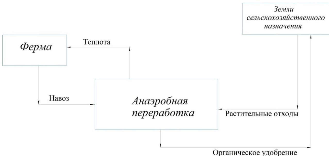
Рисунок 1 – Схема утилизации продуктов анаэробной переработки
